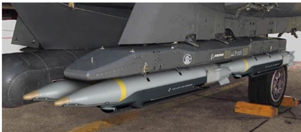
Unterflügelstation einer F-15 mit mit zwei GBU-39 Bomben / GBU = Guided Bomb Unit (Wikipedia)
